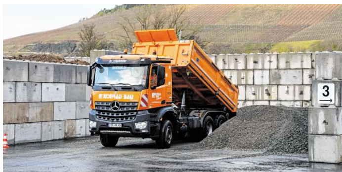
In sogenannte Boxen wird das Material im Außenlagen, wie hier der Schotter, abgekippt.
